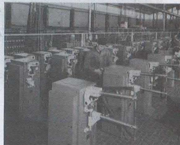
trollo elettronico della saldatura) comprendenti una vastissima gamma di tipi e di potenza (variabile questa da pochi KVA a centinaia ed anche a migliaia di KVA).
